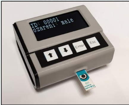
Ruční potenciostat pro zjištění míry ozáření populace po jaderné havárii
