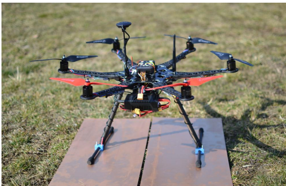
Obrázek 2: Kontaktní plochy nabíjecí stanice po přistání bezpilotního letounu.
