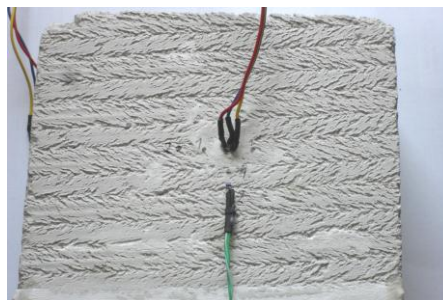
Obrázek 2: Pórobeton s připevněným bodovým zdrojem a přiloženým PT čidlem
