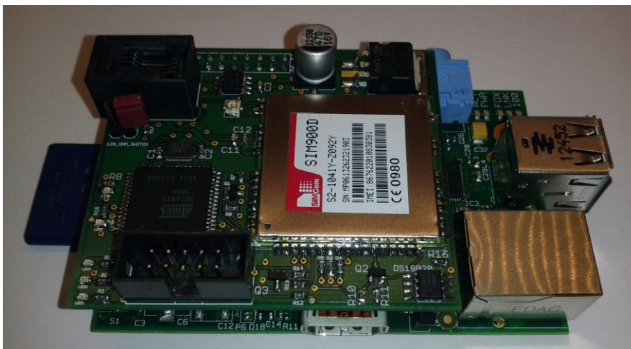
Obrázek č. 3 Výsledný osazený Raspberry pi shield připevněný na Raspberry pi
