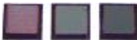
Obrázek 4: Nastříkané aktivní vrstvy (zleva: bez modifikace; 1,5% MWCNTs a 3,0% MWCNTs)
