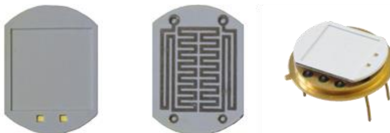
Obrázek 2: LTCC podložka s heaterem z horní a spodní strany včetně realizace na pouzdře
