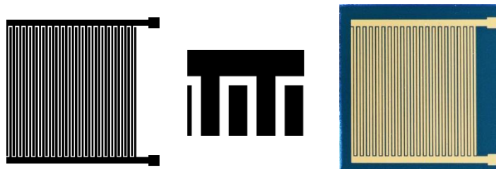
Obrázek 3: Celkový návrh, detail návrhu a zhotovený substrát s interdigitální strukturou
