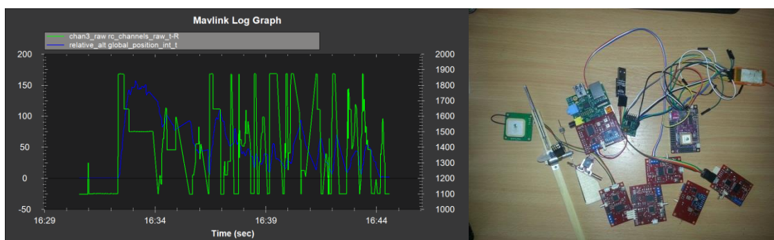
Obr. 2: Ukážka ukladaných dát (nadmorská výška- modrá a poloha páčky plynu – zelená v závislosti na čase) a vyhotovenie zariadenia
