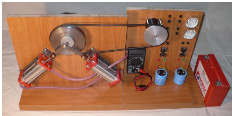
Obrázek 1: Prototyp pístové elektrocentrály a) model v SolidWorks 2012 b) skutečná podoba
