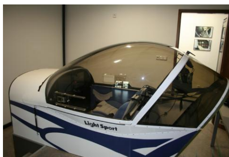
Obrázek 2: SimStar – simulátor malého sportovního letounu Evektor SportStar.[3]
