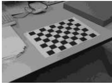
Obrázok 1: a) Príklad jedného z kalibračných snímok pre výpočet vnútorných parametrov, b) lokalizačný záber pre výpočet vonkajších parametrov kamery
