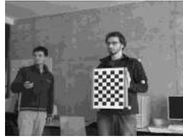
Obrázok 1: a) Príklad jedného z kalibračných snímok pre výpočet vnútorných parametrov, b) lokalizačný záber pre výpočet vonkajších parametrov kamery
