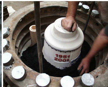
Zasypávání chromitovým písekem
