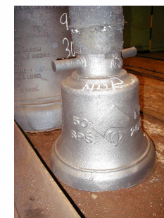
Zvon s nálitkem, bez vtokové soustavy
