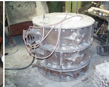
Vytvrzování pomocí CO 2
