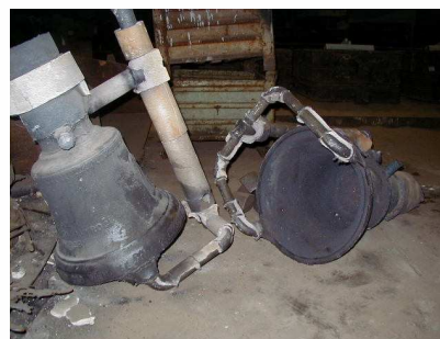
Zvony po rozbití forem
