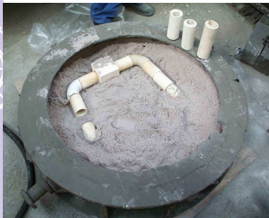
Založení vtokové soustavy
