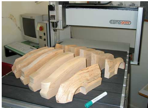
Detail obrábění Části modelu před slepením
