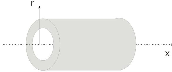
**Fig. 2:** *Tubular piezoelement*
