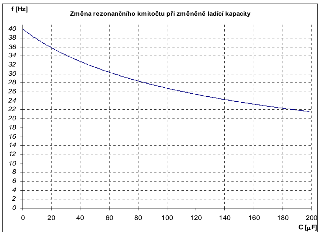
Obr. 2: Graf velikosti kapacity potřebné pro doladění na danou rezonanční frekvenci
