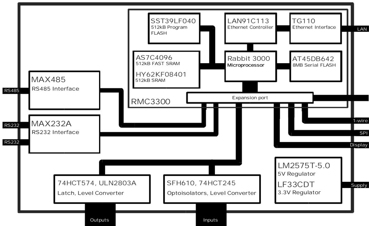
**Fig. 1:** *OMICRON-II block diagram*
